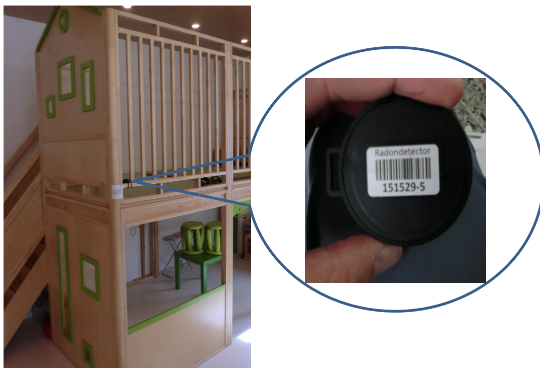
Abb. 4: Beispiel: Platzierung und Befestigung des Dosimeters, fotografischer Dokumentation.
