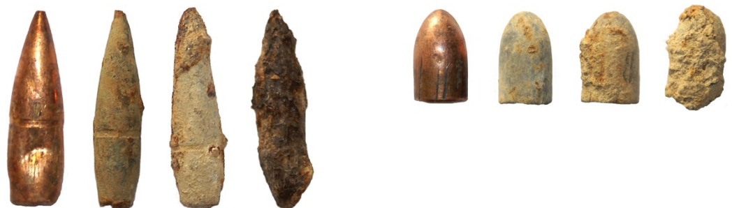
Abb. 3: Verschiedene Stadien des Zersetzungsprozesses von Geschossen in Kugelfängen Links: Gewehrprojekte GP90, rechts: 9 mm Pist Projekte Fotos: BAFU, Sektion Alt- lasten und Industrieabfälle
