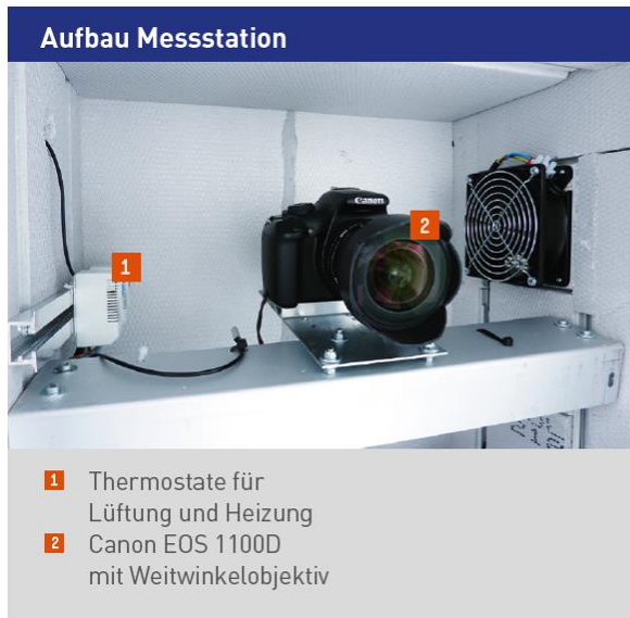
Abbildung 4: Ausstattung des Messschrank mit Kamera und Zubehör
