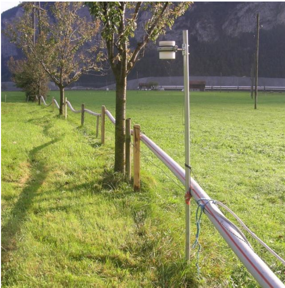
Abbildung 9: Beispiel eines NO 2 -Passivsammlers.
