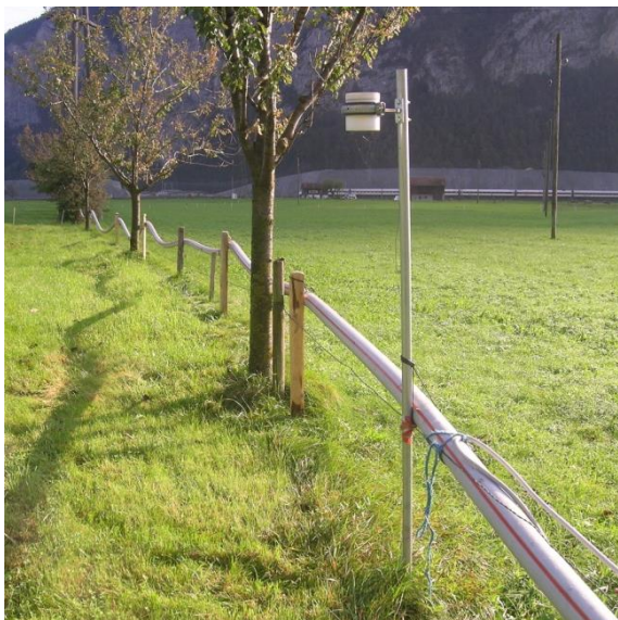
Abbildung 9: Beispiel eines NO 2 -Passivsammlers.
