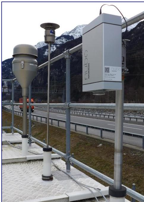
**Abbildung 2:** Der High-Volume Sampler, das Fidas- und das NuboAir-Messgerät (von hinten nach vorne) in Erstfeld.
