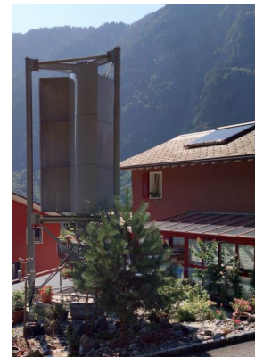
Typ «Savonius», MWKA Rotorachse vertikal Rusli, Silenen Gesamthöhe 4 m
