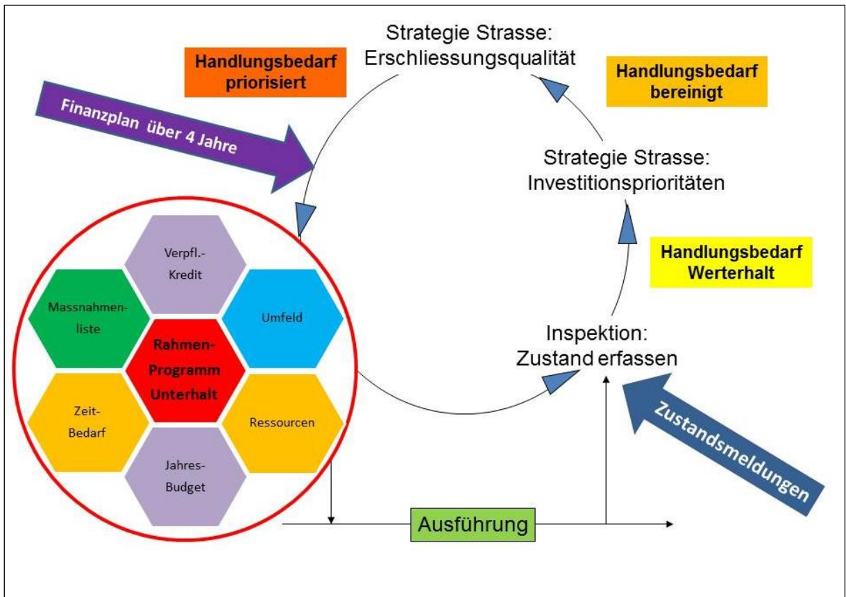
Abbildung 2: Kreislauf baulicher Unterhalt der Kantonsstrassen
