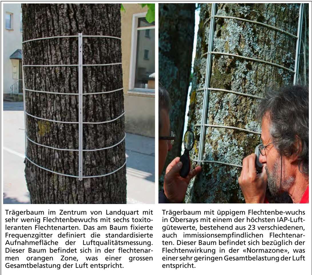
Abb. 2 Trägerbäume mit Frequenzgitter zur Messung des Luftgütewertes IAP.
