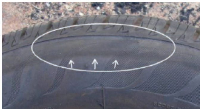
Platt gefahrener Reifen. Oft mit bläulichem Farbton verbunden.
