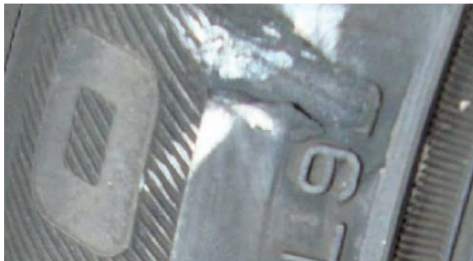
Kleine Schrammen, Stahlchord und Abdecklage nicht sichtbar.
