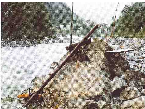
Bild 1. pH-Messstelle Nord, Messsonde in Schutzrohr.
